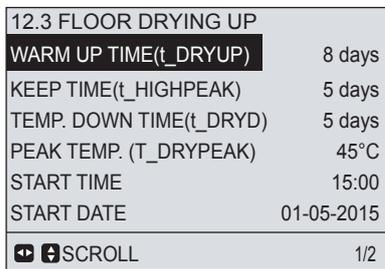
Con el cursor en **WARM UP TIME (t\_DRYUP)**, **KEEP TIME (t\_HIGHPEAK)**, **TEMP. DOWN TIME (t\_DRYD)**, **PEAK TEMP. (T\_DRYPEAK)**, **START TIME** o **START DATE**, utilice ◀ ▶ y ▼ ▲ para desplazarse y ajustar el parámetro.
