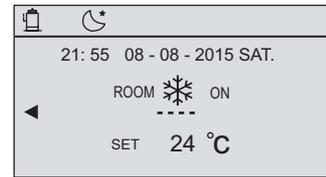
Si selecciona NON para WATER FLOW TEMP., y selecciona YES para ROOM TEMP., la temperatura de la habitación de agua se mostrará en la página de inicio, y la temperatura de la habitación actuará como la temperatura seleccionada. La temperatura seleccionada del agua de salida se puede calcular a partir de las curvas relacionadas con el clima.
