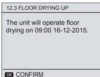
Durante el secado del suelo, todos los botones excepto OK dejan de estar operativos. Cuando la bomba de calor no funciona correctamente, el modo de secado del suelo se apagará cuando el calentador de respaldo y la fuente de calefacción adicional estén disponibles. Si desea apagar el secado del suelo, pulse OK. Se mostrará la página siguiente:
