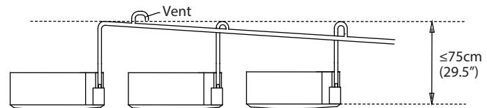
Far passare il tubo di scarico attraverso il foro nel muro. Assicuratevi che l'acqua scarichi in un luogo sicuro dove non causerà danni all'acqua o un pericolo di scivolamento.
