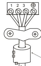
Passar a correia através do orifício do anel magnético para a fixar no cabo
