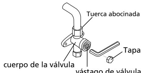
11. Con una llave hexagonal, abra completamente las válvulas de alta y baja presión.
