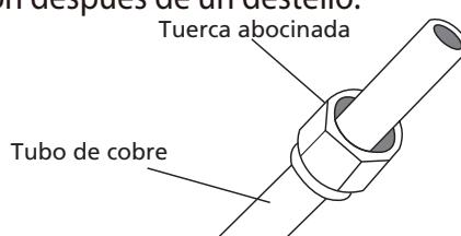
4. Quite la cinta de PVC de los extremos de la tubería cuando esté listo para realizar trabajos de abocardado.
