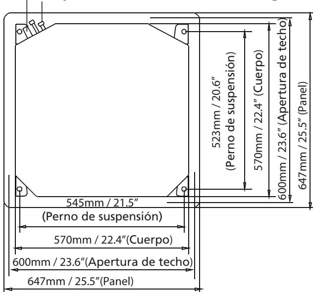
Tamaño del orificio del techo de los modelos compactos
