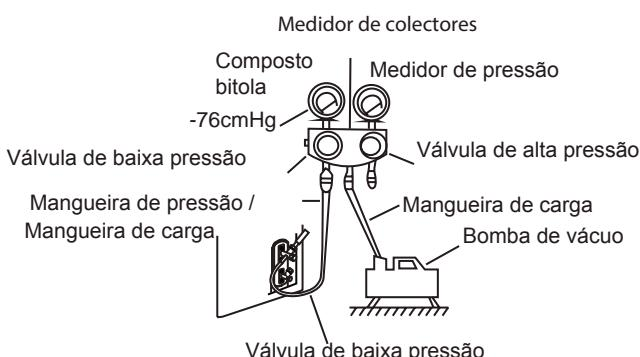
6. Fechar o lado de baixa pressão do manómetro do colector, e desligar a bomba de vácuo.
