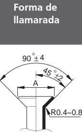
8. Retire la herramienta de abocardado y la forma de abocardado, luego inspeccione el extremo de la tubería en busca de grietas e incluso abocardado.
