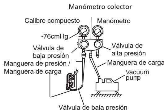
6. Cierre el lado de baja presión del manómetro del colector y apague la bomba de vacío.
