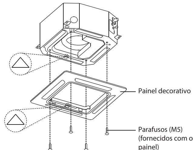
Após a instalação do painel de decoração, garantir que não há espaço entre o corpo da unidade e o painel de decoração. Caso contrário, o ar pode vazar através do espaço e causar gota de orvalho. (Ver figura abaixo)
