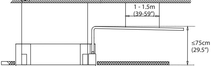
**NOTA:** Cuando conecte varios tubos de drenaje, instale los tubos como se ilustra en la siguiente figura.
