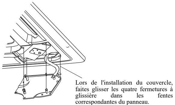
**REMARQUE:** Après l'installation, les fiches de l'écran, de la balançoire, de la pompe à eau et des autres corps de câble doivent être placées dans le boîtier de commande électrique.
