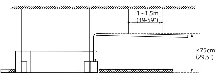
**NOTA:** Quando si collegano più tubi di drenaggio, installare i tubi come illustrato nella seguente figura.
