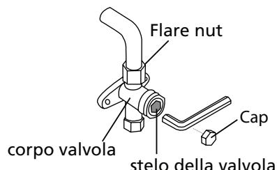
12. Utilizzando una chiave esagonale, aprire completamente le valvole di alta e bassa pressione.
