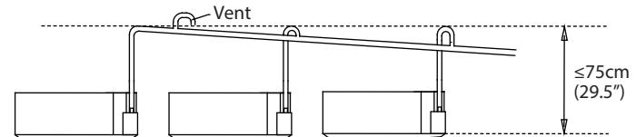
Passar a mangueira de drenagem através do buraco da parede. Certificar-se de que a água drena para um local seguro onde não causará danos ou um risco de escorregamento.
