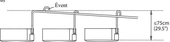
Faites passer le tuyau de drainage par le trou dans le mur. Assurez-vous que l'eau s'écoule vers un endroit sûr où elle ne causera pas de dégâts d'eau ou de risque de glissade.
