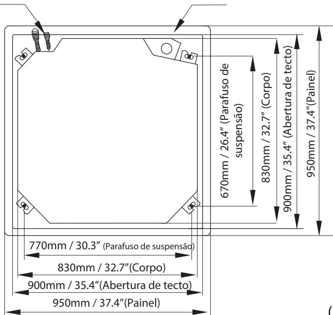
**5. Montar a unidade interior.** Serão necessárias duas pessoas para a levantar e fixar. Insira os parafusos de suspensão nos orifícios de suspensão da unidade. Fixá-los usando as arruelas e porcas incluídas.
