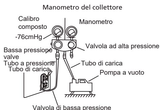
6. Chiudere il lato di bassa pressione del manometro del collettore e spegnere la pompa a vuoto.
