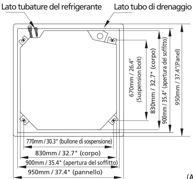
5. Montare l'unità interna. Sono necessarie due persone per sollevarla e fissarla. Inserire i bulloni di sospensione nei fori di sospensione dell'unità. Fissarli usando le rondelle e i dadi inclusi.
