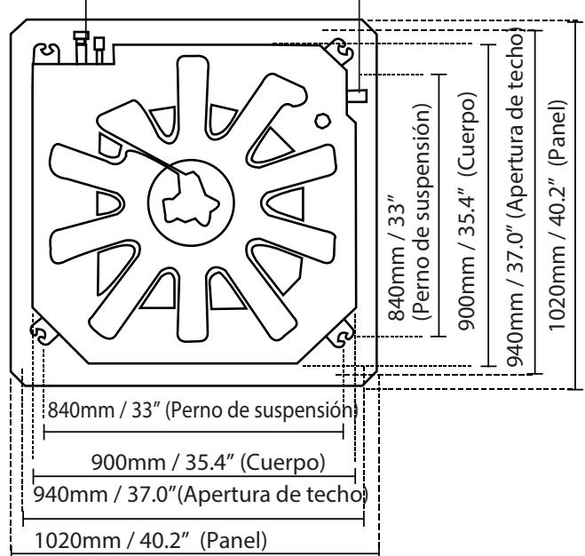
60K Tamaño del orificio del techo de los modelos superdelgados
