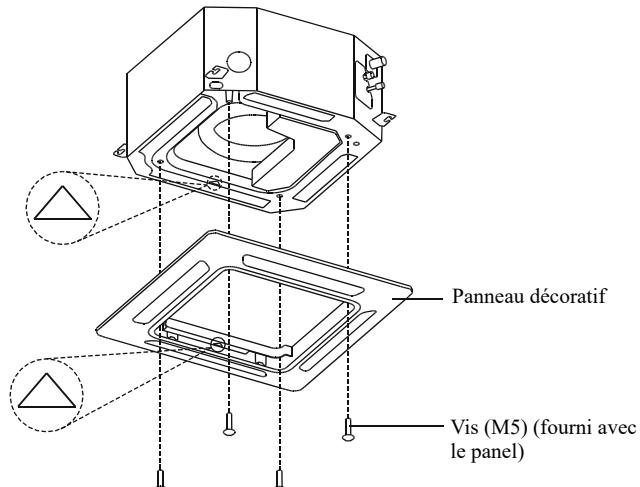
Après avoir installé panneau de décoration, assurez-vous qu'il n'y a pas d'espace entre le corps de l'appareil et le panneau de décoration. Sinon, de l'air pourrait s'échapper par l'espace et provoquer des gouttes de rosée. (Voir la figure ci-dessous)
