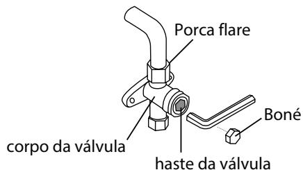
12. Usando chave hexagonal, abrir completamente tanto as válvulas de alta pressão como as de baixa pressão.
