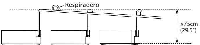
Pase la manguera de desagüe a través del orificio de la pared. Asegúrese de que el agua se drene a un lugar seguro donde no cause daños por agua o un peligro de resbalones.
