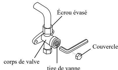
12. À l'aide d'une clé hexagonale, ouvrez complètement les vannes haute et basse pression.
