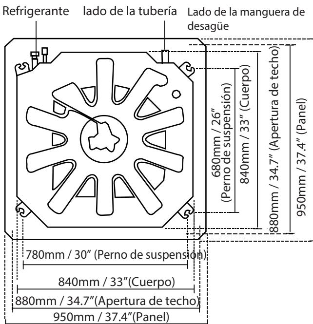
18-48K Tamaño del orificio del techo de los modelos superdelgados
