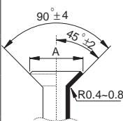
8. Retirar a ferramenta de queima e a forma de queima, depois inspecionar a extremidade do tubo para detectar fissuras e até mesmo a queima.
