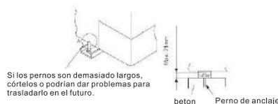
Fig. 2 Instalación de los pernos de anclaje
