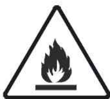
Cuidado: Risco de incêndio
