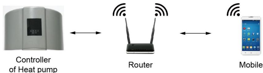
Encienda la unidad de bomba de calor y mantenga presionado el botón del temporizador y el botón de aumento al mismo tiempo durante 5 segundos. El ícono SET parpadeará. Cuando el indicador de Wi-Fi siga parpadeando rápidamente, haga clic en "Confirmar que el indicador parpadee rápidamente".
