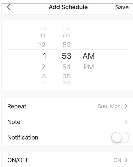
En esta interfaz, configure la hora y el día para que el temporizador se encienda y se apague. Después de la configuración, haga clic en "Guardar" para confirmar y guardar. La configuración del temporizador se mostrará en la siguiente interfaz. En esta interfaz, haga clic en "Aregar programa" para agregar otro temporizador de ON/OFF.
