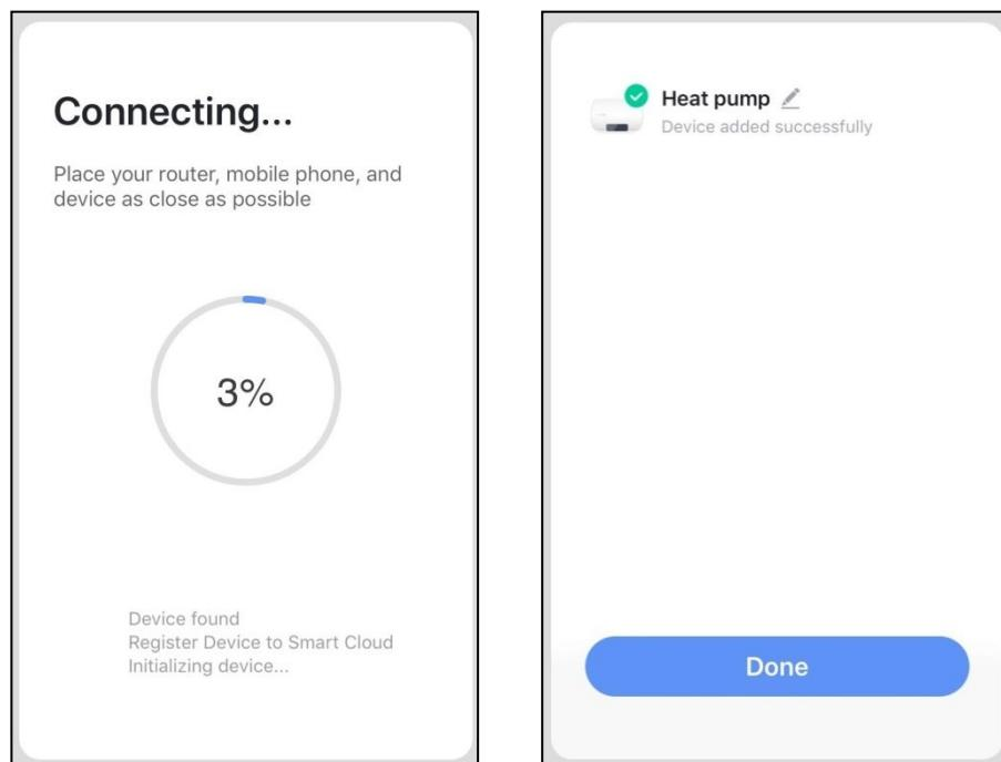
En esta interfaz, el dispositivo (unidad de bomba de calor) se puede nombrar como deseé. Haga clic en "Listo" para finalizar la instalación de la aplicación. La pantalla del dispositivo móvil mostrará la interfaz de control de la aplicación.
