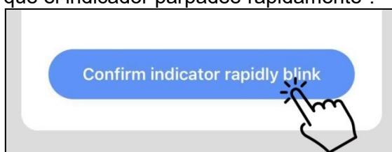
Notas: Cuando el ícono del conjunto parpadea rápidamente, significa que el controlador está en modo Wi-Fi. Cuando parpadea lentamente, significa que el controlador se está conectando con la aplicación. Durante la conexión, si el ícono del conjunto se apaga, significa que la conexión de la APLICACIÓN con la unidad ha finalizado.
