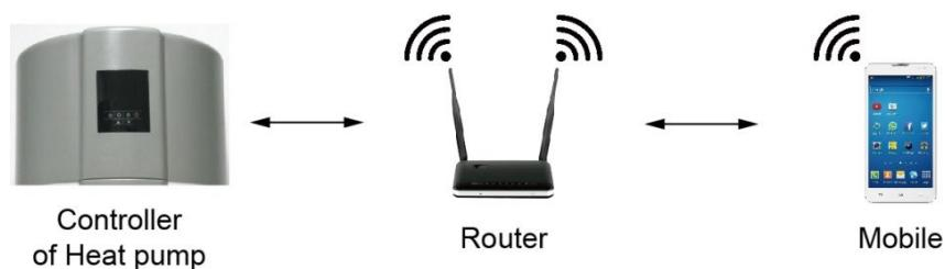
Encienda la unidad de bomba de calor y mantenga presionado el botón del temporizador y el botón de aumento al mismo tiempo durante 5 segundos. El icono SET parpadeará. Cuando el indicador de Wi-Fi siga parpadeando rápidamente, haga clic en "Confirmar que el indicador parpadee rápidamente".
