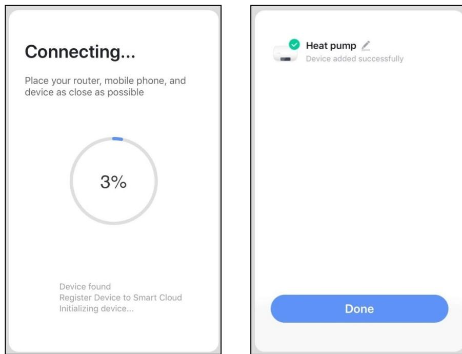
Dans cette interface, l'appareil (pompe à chaleur) peut être nommé à votre guise. Cliquez sur "Terminé" pour terminer l'installation de l'application. L'écran de l'appareil mobile affichera l'interface de contrôle APP.
